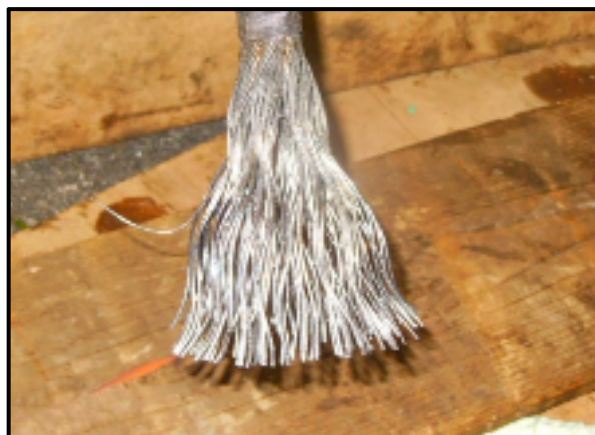
【切り詰められた索条の端部】
